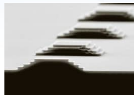
SiO 2 エッチング加工 (4段エッチング加工)
