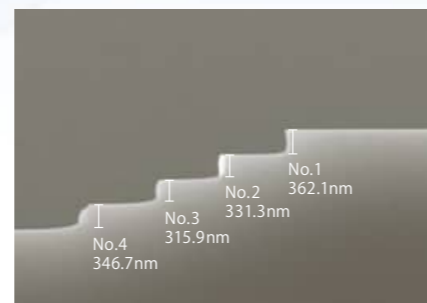
SiO 2 エッチング加工 (4段エッチング加工)
