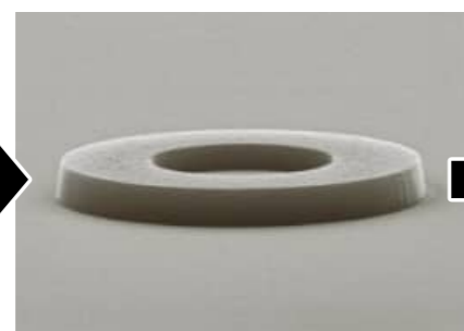
SiO 2 エッチング加工 (2段エッチング加工)
