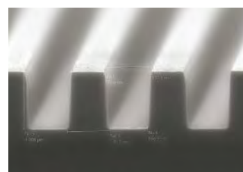
SiO 2 エッチング加工 L/S 0.7μm
